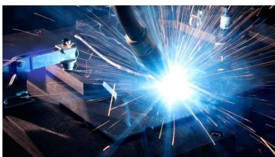
Lichtbogenschweißen, oder MSG-Schweißen (Metall-Schutzgas-Schweißen), ist in der metallverarbeitenden Industrie, im Container- und Behälterbau, im Maschinenbau, im Schienenfahrzeug- und Schiffsbau aber auch in der Möbelindustrie und anderen Branchen weit verbreitet. Das Verfahren ermöglicht das Fügen dünner Bleche ebenso wie von Bauteilen mit
